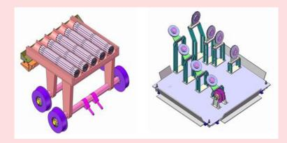
(d) Trolley Sub-assembly (e) Guide Pulleys (Pool Side)
