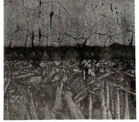
चित्र-4 : परिवर्तन द्रवण क्रांतिक तरल अवस्था में बनाये गये विसरण जोड़ के अनुप्रस्थ परिच्छेद का प्रकाशीय सूक्ष्मदर्शी फोटोग्राफ
