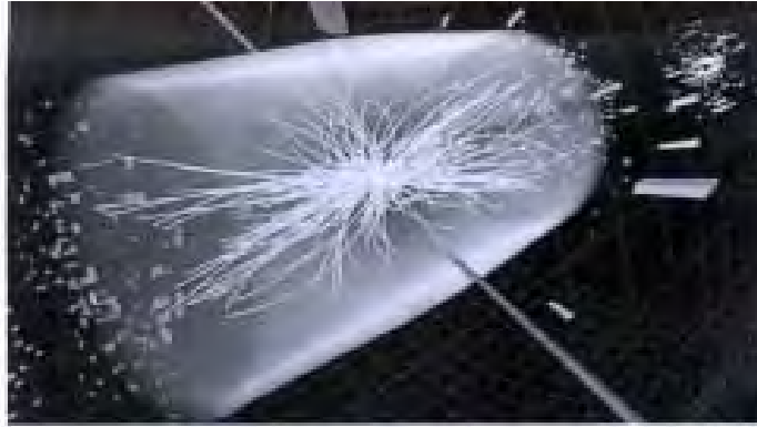
2012 में 8 सीएमएस से रिकॉर्ड की गई घटना जो स्टैंडर्ड मॉडल हिग्स बोसोन के फोटॉनों के एक युग्म में क्षय से अपेक्षित लक्षणों को दिखाती है.
