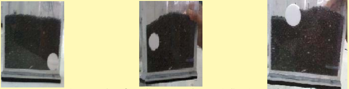
चित्र 4 : द्विआयामी संस्तर को उर्ध्व-तल में कम्पित करने पर तली में रखी प्लास्टिक की डिस्क का ऊपर की ओर जाने की विभिन्न स्थितियां
