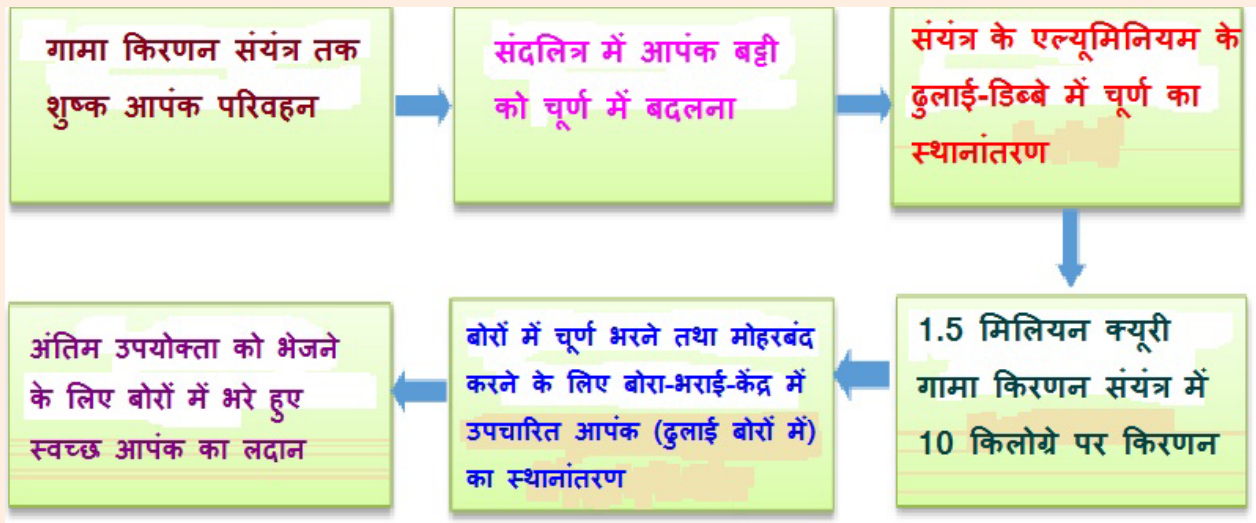
योजना (स्कीम) 1 : शुष्क मलजल आपंक हेतु 100 टन/दिन विकिरण स्वच्छता संबंधी प्रक्रम प्रवाह-पत्र आरेख
