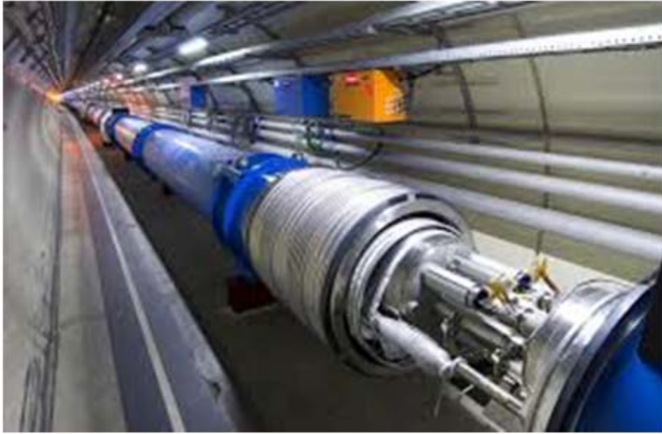
चित्र 11: लार्ज हैड्रोन कोलाइडर, वृहद हैड्रोन संघट्टक (LHC), सी ई आर एन (CERN) में सुपर कंडक्टर्स का उपयोग (पार्टिकल एक्सलेरेटर में सुपरकंडक्टिविटी)
