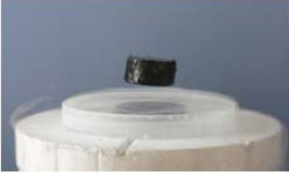
चित्र 2(b): माइसनेर प्रभाव के कारण हवा में तैरती चुंबक चित्र 2C: चुंबकीय उत्तोलन का सिद्धांत
